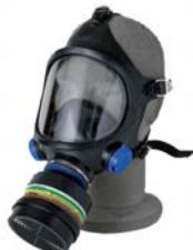
Maschera a pieno facciale di taglia universale senza dispositivo fonico. Ampio schermo in policarbonato con trattamento antiacido e antigraffio. Raccordo filettato UNI EN 148/1 per l'impiego di filtri della serie Dirin 230, Dirin 300, Dirin 500 e tramite adattatore di filtri della serie 230.
