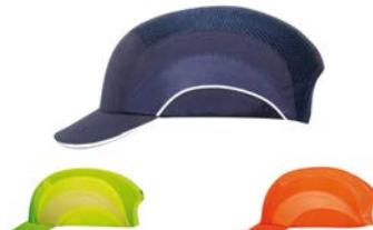
Berretto progettato per proteggere la testa da urti e graffi accidentali. Fascetta regolabile con una sola mano, imbotitura in neoprene espanso, fascia anti-sudore in spugna e dodici punti di ventilazione. Rivestito tela. Test di impatto a 30 ° e 60 ° dalla corona, oltre ai normali test richiesti da EN812. Non utilizzare in un area nella quale è necessario un elmetto industriale di protezione. Altri colori disponibili su richiesta.
