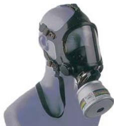
Maschera a pieno facciale di taglia universale con dispositivo fonico. Ampio schermo in policarbonato con trattamento antiacido e antigraffio. Raccordo filettato UNI EN 148/1 per l'impiego di filtri della serie Dirin 230, Dirin 300, Dirin 500 e tramite adattatore di filtri della serie 230.
