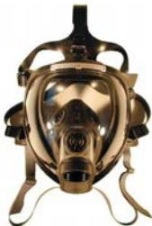
Maschera a pieno facciale di taglia universale con dispositivo fonico. Schermo panoramico in policarbonato con trattamento antiacido e antigraffio. Raccordo filettato UNI EN 148/1 per l'impiego di filtri della serie Dirin 230, Dirin 300, Dirin 500 e tramite adattatore di filtri della serie 230.
