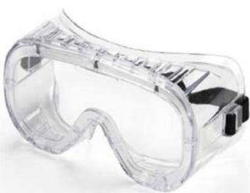
Occhiale a mascherina realizzato in plastica trasparente, fascia elastica in tessuto, quattro tappi di aerazione, lenti in policarbonato antiappannante. Protegge da gocce, spruzzi e da particelle di polveri maggiori di 5 micron.
