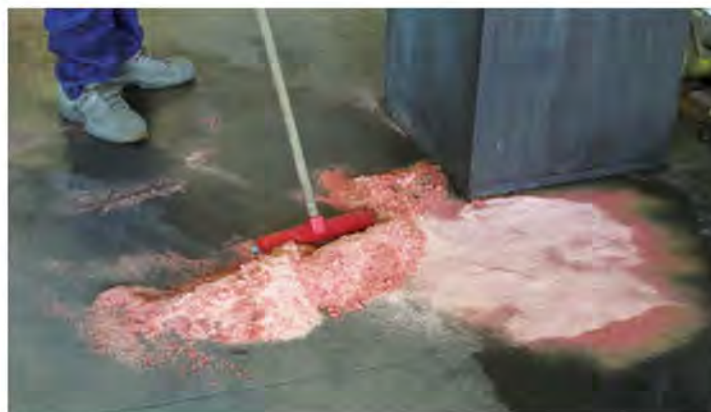
APPLICAZIONE MULTSORB-C SU SVERSAMENTO OLIO MECCANICO IN AMBIENTE INDUSTRIALE
